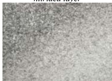
Middle layer hardness: 412 HV, 516 HV, 549 HV
